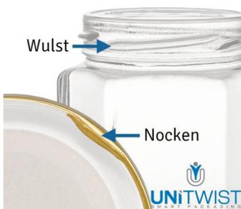
Twist-Off Gläser haben an der Öffnung aussen schräge Wülste. In Diese greifen genau passend kleine Ausbuchtungen (Nocken) des Metall-Deckels. Damit ein Twist-Off Deckel luftdicht schliesst, ist an der Innenseite zum Glas hin eine Dichtung aufgeklebt.
